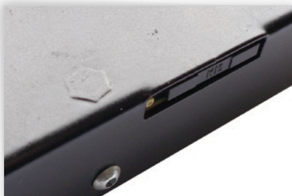
Slot pre SIM kartu v GPS zariadení AM04 Classic
