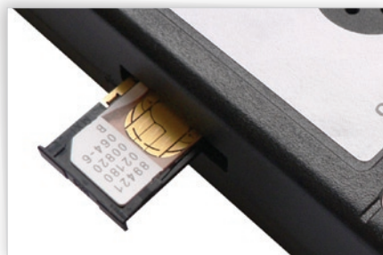
Slot pre dátovú SIM kartu v GPS zariadení AM05 Basic
